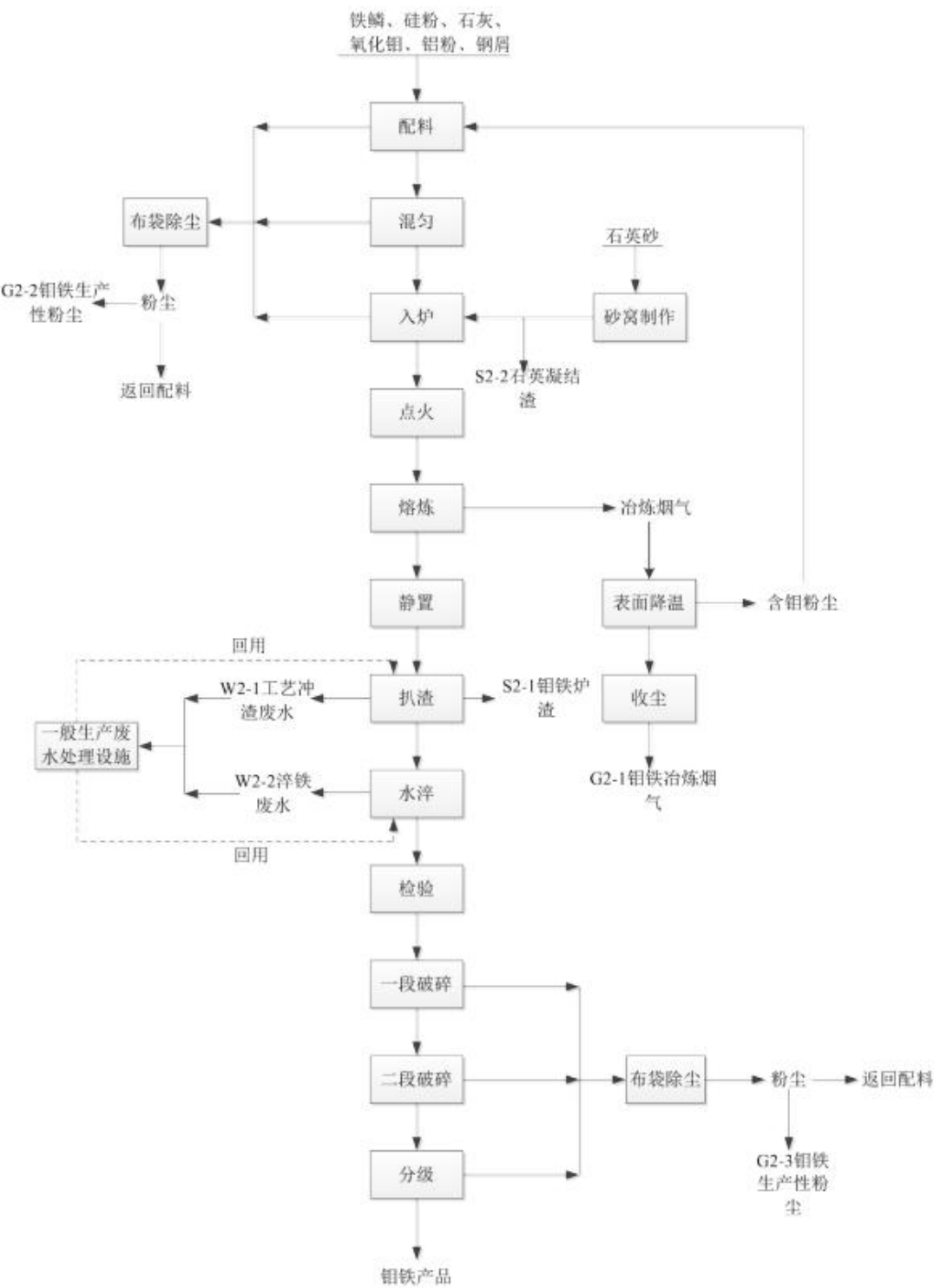
图 2-3 钕铁生产工艺生产流程及产污节点图
